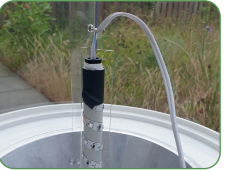
Der Lichtsensor ist an der Schraube befestigt.
