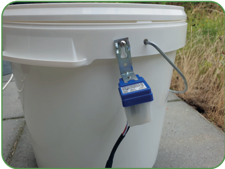
Der Lichtsensor ist an der Schraube befestigt.
