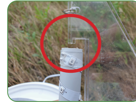
Skjut röret över plattans spetsar.
