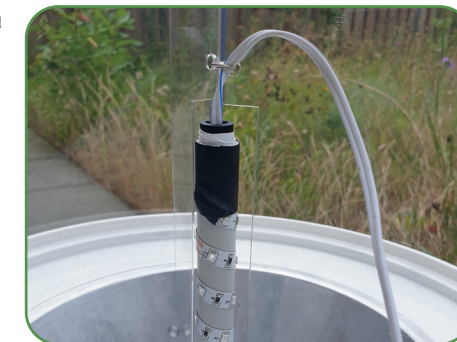
Ljussensorn är fäst vid skruven.
