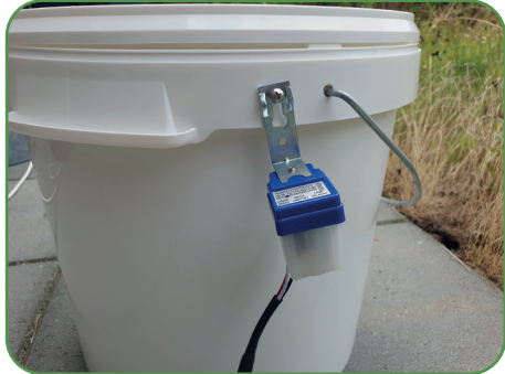
El sensor de luz está sujeto al tornillo.
