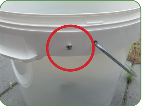
Este es el tornillo para el sensor de luz.
