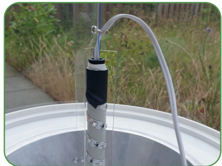
El sensor de luz está sujeto al tornillo.
