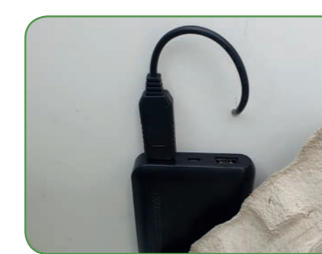
Gebruik bij voorkeur de USB-aansluiting met één bliksemschicht.
