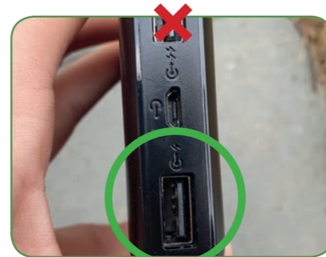
Gebruik bij voorkeur de USB-aansluiting met één bliksemschicht.
