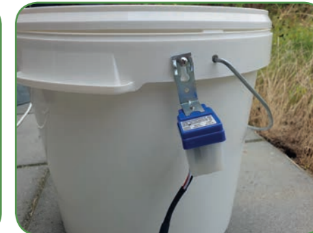
De lichtsensor wordt bevestigd aan de schroef.
