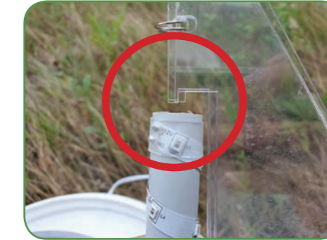
Schuif het buisje over de puntjes van de plaatjes.
