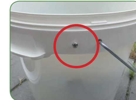
Dit is de schroef voor de lichtsensor.
