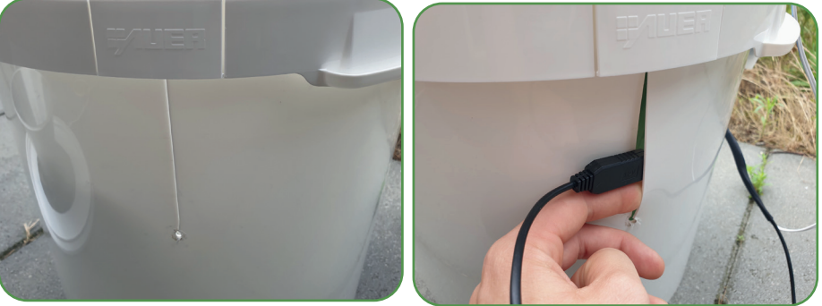
Aprire la fessura leggermente con le dita per permettere al cavo di USB di passare attraverso.
