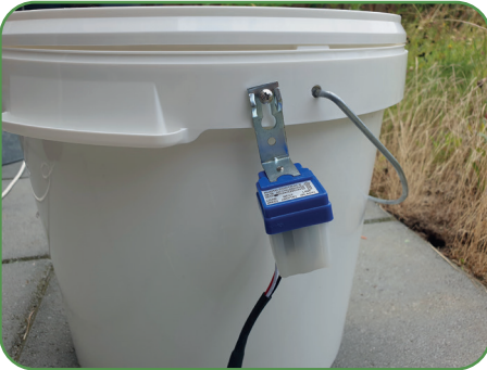
Il sensore luminoso è agganciato alla vite.
